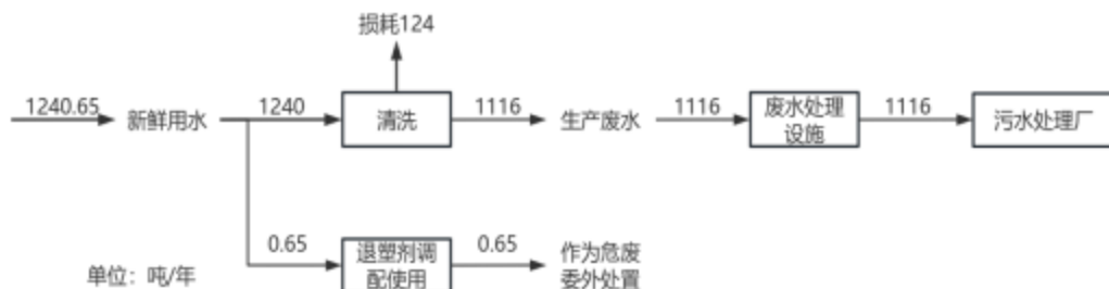
图 2-1 项目水平衡图
