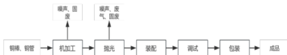
图 2-9 现有项目洗眼器（铜材质）生产工艺流程及产污环节示意图
