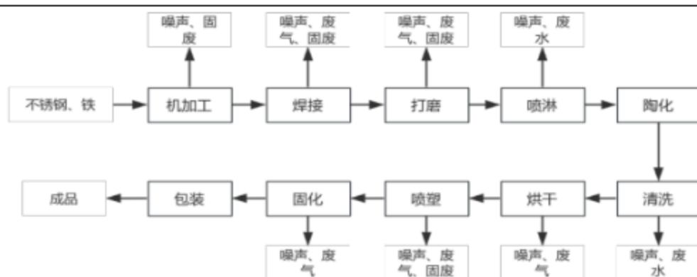
图 2-7 现有项目通风柜（需陶化）生产工艺流程及产污环节示意图
